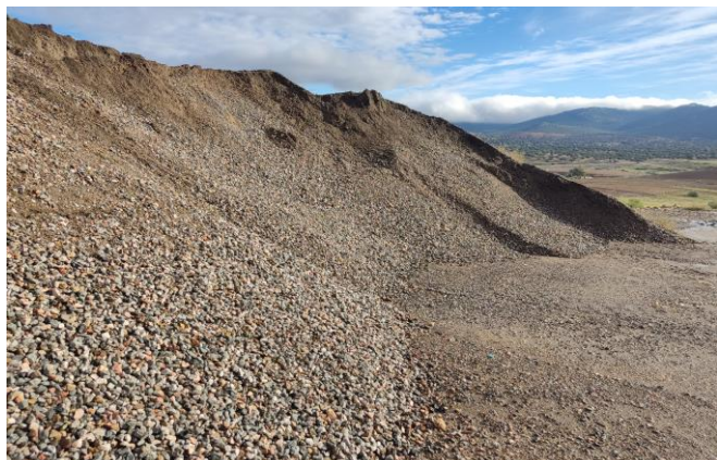
Ilustración 5. Árido reciclado de balasto de vías férreas.
